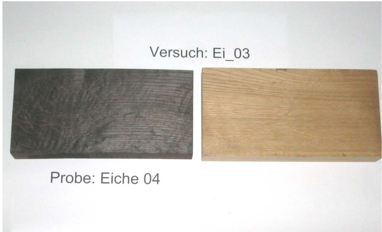
Bild 5: Behandelte und unbehandelte Holzprobe (Versuch EI_03)
