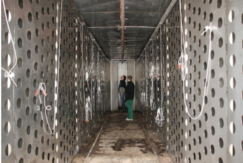
Bild 8: Kammer von innen mit Leitblechen
